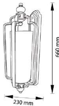
D 58-80021-1W SIZE : D : 250x660 mm H : 230 mm LAMP : E27 x 1 MATERIEL : STEEL-GLASS
